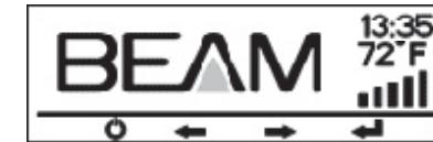
La vista principal destellando indica que la unidad motriz se recuperó automáticamente de una situación de error y funcionará correctamente al encenderla.
